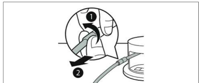
Abb. 6.3 Vakuumschlauch aus der Kupplung lösen
