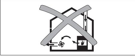
**Fig. 6.24** Montage avec évacuation d'air - non- autorisé
