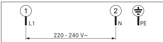
Fig. 5.12 Esquema de conexión monofásica
