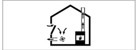
Abb. 9.2 Abluftmontage – korrekt
