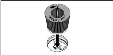
Kuva 7.7 Aktiivihiilisuodattimen asettaminen tuloaukkoon
