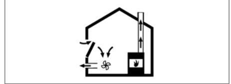
Kuva 9.2 Poistoilman asennus – oikein
