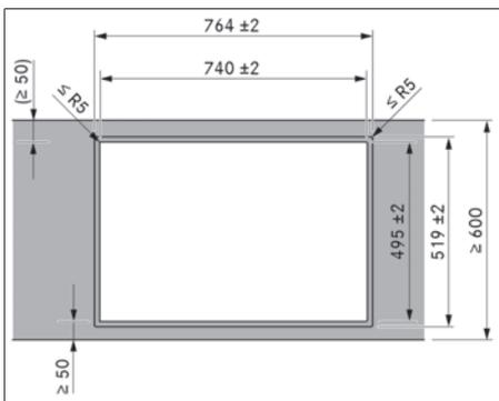
Fig. 9.5 Dimensions de découpe pour montage affleurant
