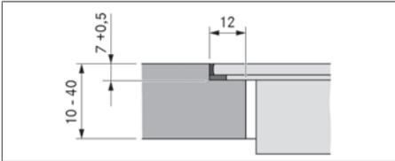
Fig. 9.6 Dimension de rainure pour montage affleurant
