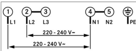
Fig. 9.29 Schéma de raccordement biphasé
