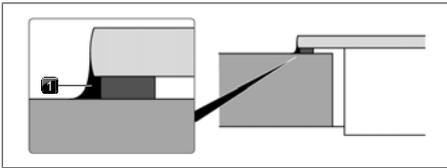
Fig. 9.35 Joint en silicone en montage en saillie
