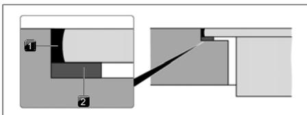
Fig. 9.18 Ruban d'étanchéité pour montage affleurant
