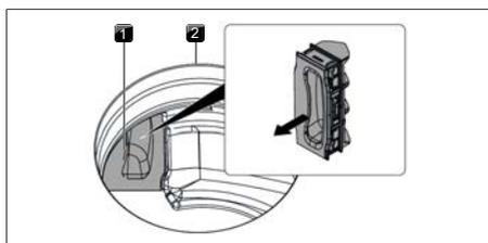
Fig. 7.3 Retrait du clapet de changement de filtre
