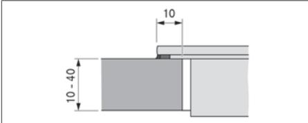
Fig. 9.8 Cote d'appui pour montage en saillie
