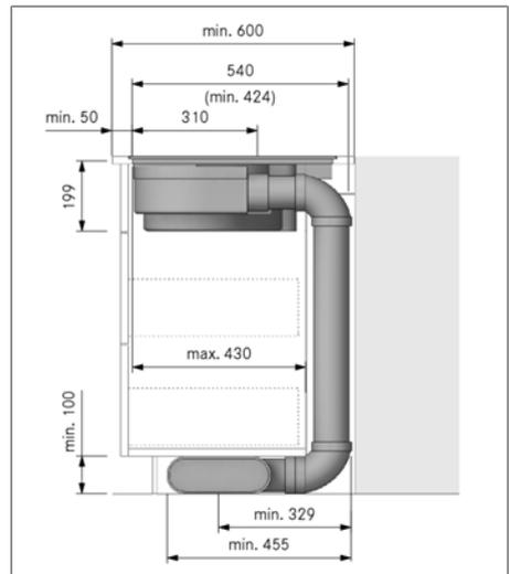
Fig. 9.9 Cotes de montage en mode évacuation d'air, profondeur du plan de travail 600 mm
