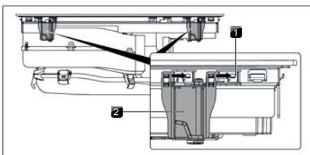
Fig. 9.19 Pose des pinces de montage
