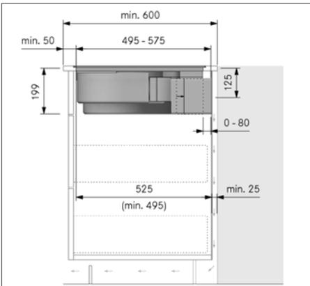
Fig. 9.13 Dimensions de montage pour le recyclage d'air, variante A
