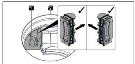
Fig. 7.9 Pose du clapet de changement de filtre
