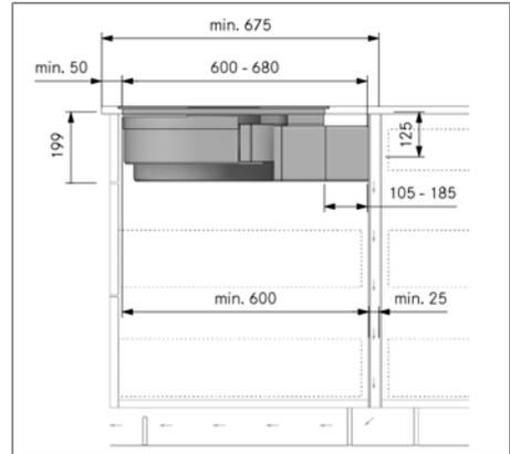
Fig. 9.14 Dimensions de montage pour le recyclage d'air, variante A, profondeur du plan de travail à partir de 675 mm
