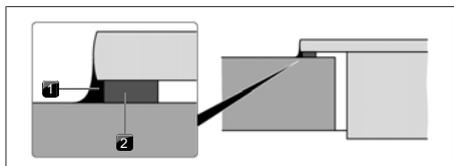
Fig. 9.17 Ruban d'étanchéité pour montage en saillie
