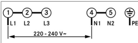
Fig. 9.28 Schéma de raccordement monophasé
