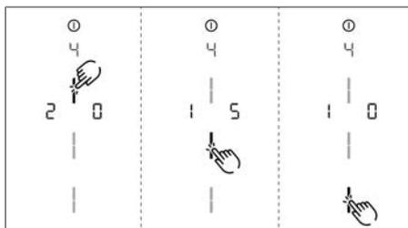
Fig. 6.4 Option de menu 5 : Sélection de la durée de la temporisation automatique :
