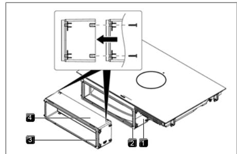
Fig. 9.15 Extension de la section télescopique
