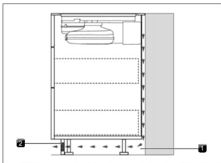
Fig. 9.10 Ouverture de retour de flux dans le socle
