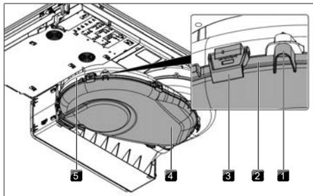
Fig. 7.2 Boîtier de circulation de l'air
