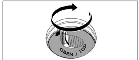
Fig. 7.8 Positionnement du filtre à charbon actif
