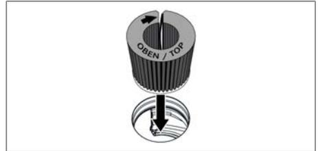
Fig. 7.7 Insertion du filtre à charbon actif dans l'ouverture d'aspiration
