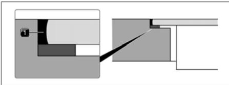
Fig. 9.36 Joint en silicone en montage affleurant
