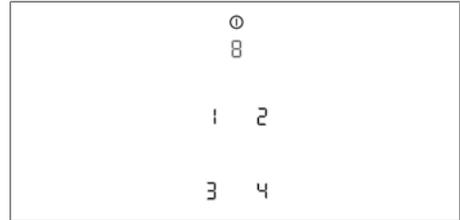
Fig. 6.8 Option de menu 8 : Version logicielle/matérielle
