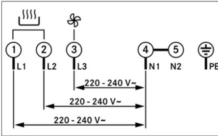
Fig. 9.27 Schéma de raccordement triphasé
