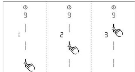
Fig. 6.9 Option de menu 9 : Arrêt de sécurité
