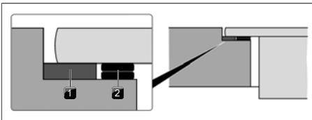
Fig. 9.22 Plaques de compensation des hauteurs
