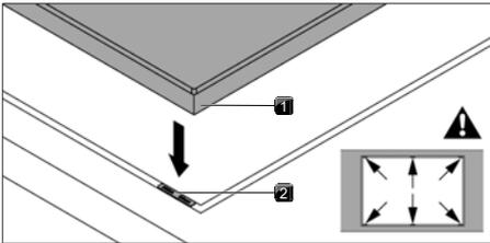
Fig. 9.21 Positionnement des plaques de compensation des hauteurs
