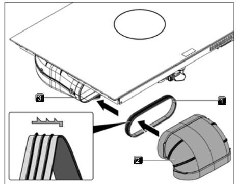
Fig. 9.24 Raccordement au système de canaux
