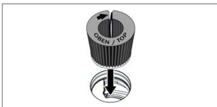
Afb. 7.7 Actieve-koolfilter in afzuigopening plaatsen
