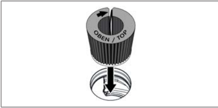
Obr. 7.7 Vloženie filtra s aktívnym uhlím do odťahového otvoru
