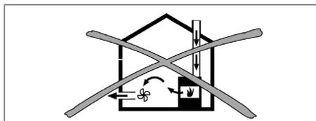
Fig. 11.1 Montaggio scarico aria – non consentito
