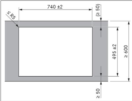
Fig. 11.7 Dimensioni intaglio per montaggio in battuta
