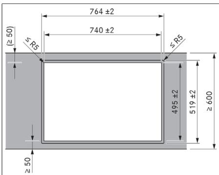
Fig. 11.5 Dimensioni intaglio per montaggio a filo
