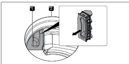
Fig. 9.4 Rimuovere la valvola di sostituzione del filtro
