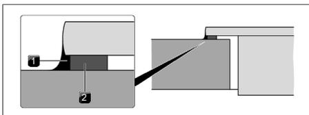
Fig. 11.17 Nastro a tenuta per montaggio in battuta
