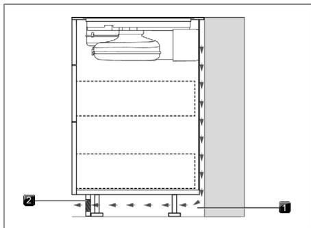
Fig. 11.10 Apertura di sfogo nell'area dello zoccolo
