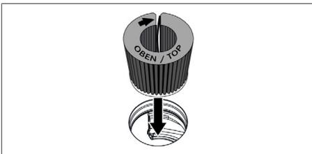
Fig. 9.8 Inserire il filtro antiodori nell'apertura di aspirazione
