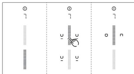
Fig. 8.8 Voce di menu 7: Riconoscimento pentola permanente
