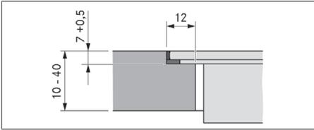
Fig. 11.6 Dimensioni dell'incassatura per montaggio a filo piano
