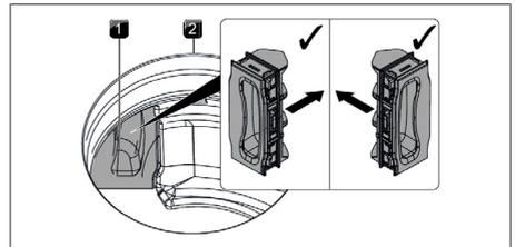
Fig. 9.10 Inserire la valvola di sostituzione del filtro
