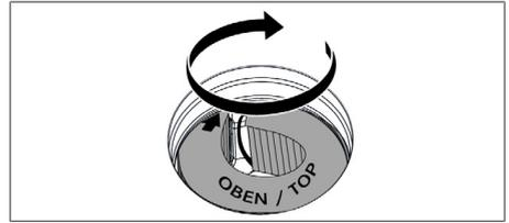
Fig. 9.9 Posizionare il filtro antiodori nella posizione finale
