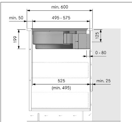
Fig. 11.13 Dimensioni di montaggio con sistema filtrante, variante di montaggio A
