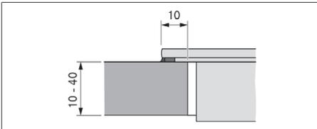
Fig. 11.8 Misura d'appoggio per montaggio in battuta
