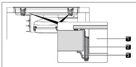
Fig. 11.23 Fissare il piano cottura nel centro
