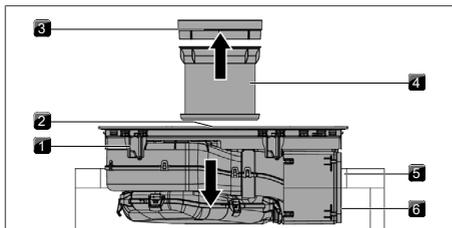
Fig. 11.20 Inserire il piano cottura nel centro
