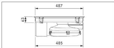
Fig. 3.6 PURMU2/R dimensões do aparelho vista lateral
