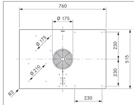
Fig. 3.1 PURMA2/R dimensões do aparelho vista de cima
