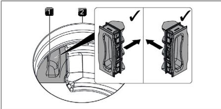
Fig. 9.10 Inserir a tampa de troca do filtro
