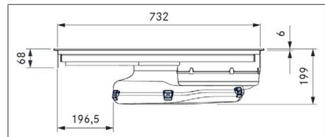
Fig. 3.2 PURMA2/R dimensões do aparelho vista frontal
