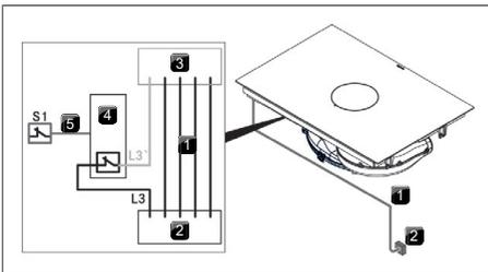
Fig. 11.26 Esquema de ligação com comutador externo
