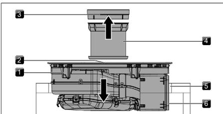
Fig. 11.20 Colocar a placa de cozinhar centrada
