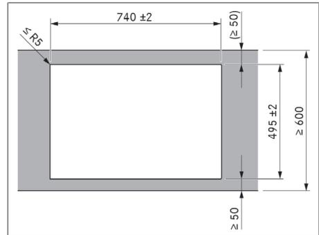
Fig. 11.7 Medidas de recorte para montagem por sobreposição
