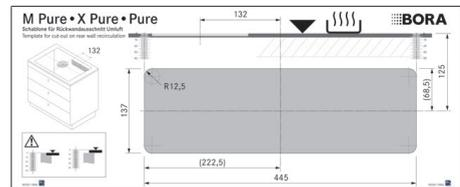
Fig. 11.12 Molde para o recorte do painel traseiro
