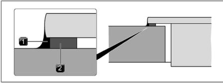
Fig. 11.17 Cinta vedante para montagem por sobreposição
