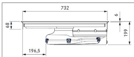
Fig. 3.5 PURMU2/R dimensões do aparelho vista frontal
