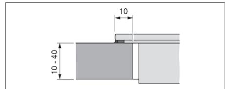
Fig. 11.8 Medida do apoio para montagem por sobreposição
