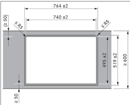
Fig. 11.5 Medidas de recorte para montagem à face
