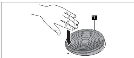
Fig. 9.1 Remover a grelha de entrada de ar
