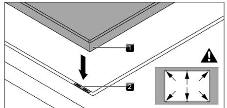
Fig. 11.21 Posicionamento e placas de compensação de altura
