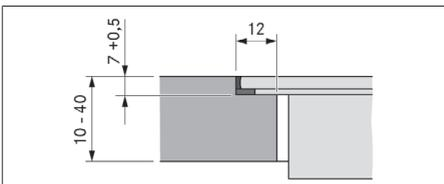
Fig. 11.6 Medida de recesso para montagem à face
