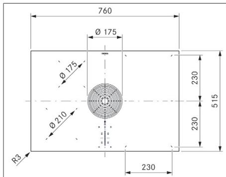
Fig. 3.4 PURMU2/R dimensões do aparelho vista de cima
