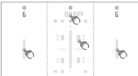
Fig. 8.7 Opção de menu 6: Teste dos LED
