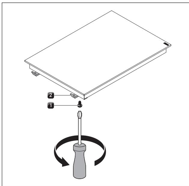
Fig. 5.16 Pattes de fixation
