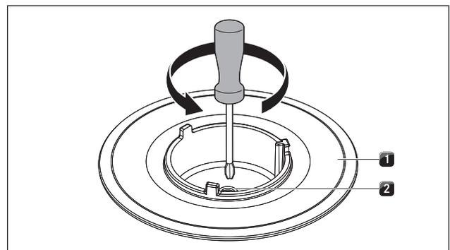
Abb. 6.3 Kochstellenbrenner mit Gas-Brennerdüse
