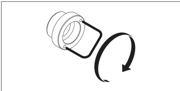
Abb. 5.11 Befestigungsmutter anziehen
