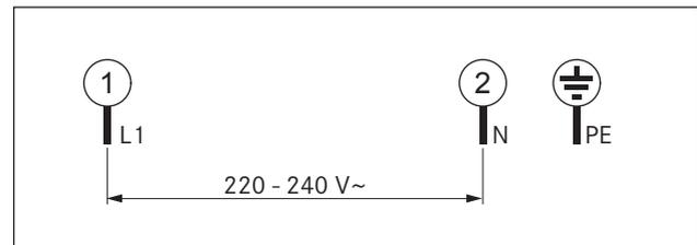
Abb. 5.2 Anschlussschema 1-phasig
