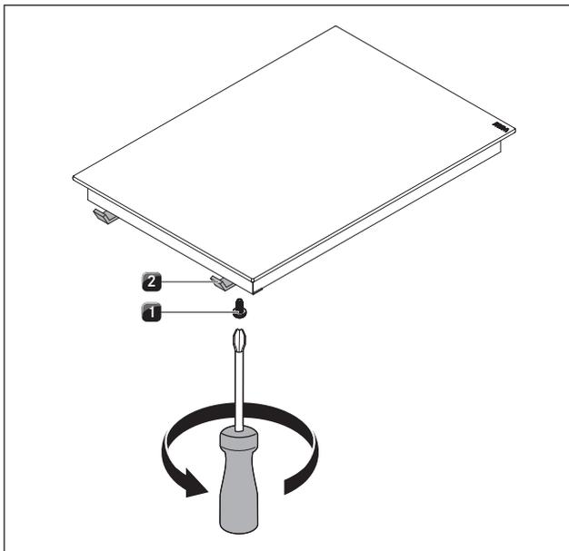
Abb. 5.16 Befestigungsklammern
