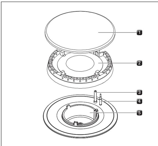
Abb. 8.1 Gas-Brenner Aufbau
