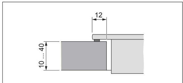
Abb. 5.6 Schnitt Aufsatzmontage
