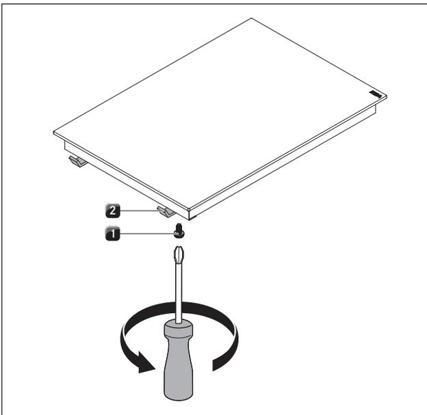
Fig. 5.16 Clips de montaje
