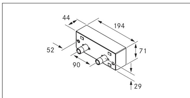
Fig. 3.2 Dimensions du boîtier de commande
