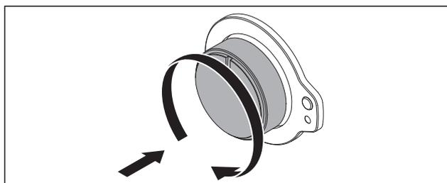
Fig. 6.1 Appuyer sur le bouton de commande et tournez-le
