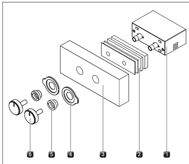
Fig. 5.9 Montage boîtier de commande
