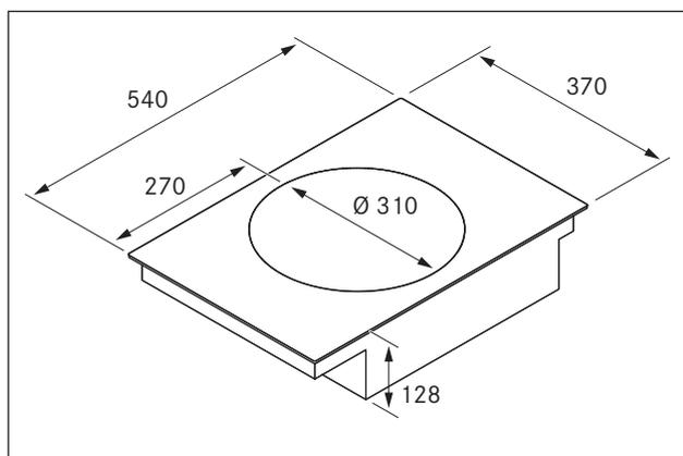
Fig. 3.1 Dimensions de l'appareil
