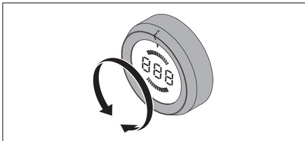
Fig. 6.2 Encendido de la zona de cocción
