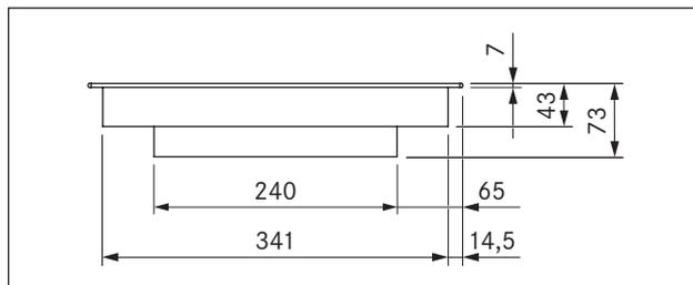
Fig. 3.5 PKC3B dimensiones del aparato vista frontal
