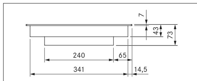
Fig. 3.2 PKC32 dimensiones del aparato vista frontal
