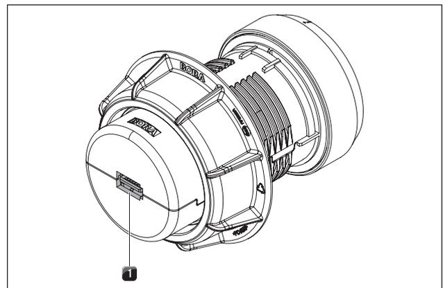
Fig. 5.18 Conexión en la parte trasera del mando selector
