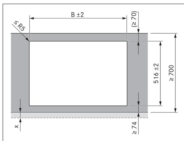
Fig. 5.5 Medidas del recorte para montaje superpuesto
