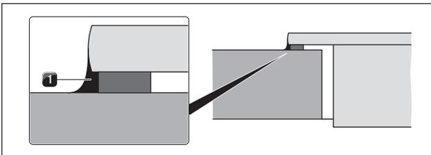
Fig. 5.26 Silicona de sellado para montaje superpuesto
