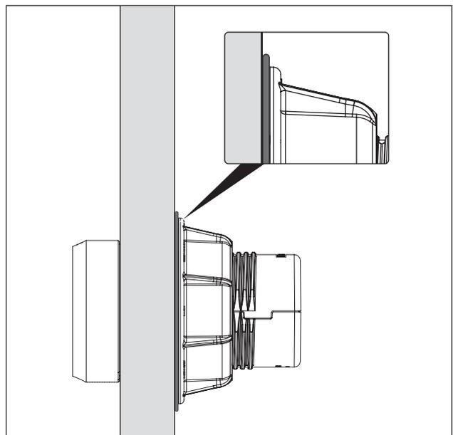
Fig. 5.11 Anillo elástico tras finalizar el montaje
