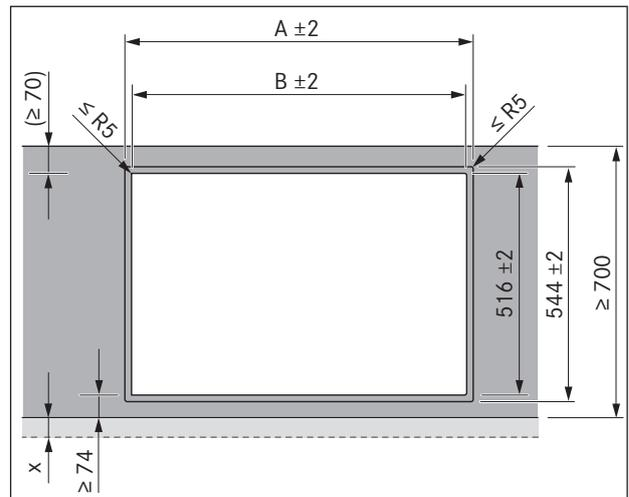
Fig. 5.3 Medidas del recorte para montaje enrasado
