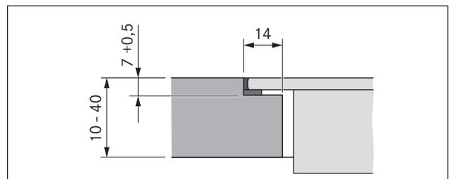
Fig. 5.4 Medida del pliegue para un montaje enrasado
