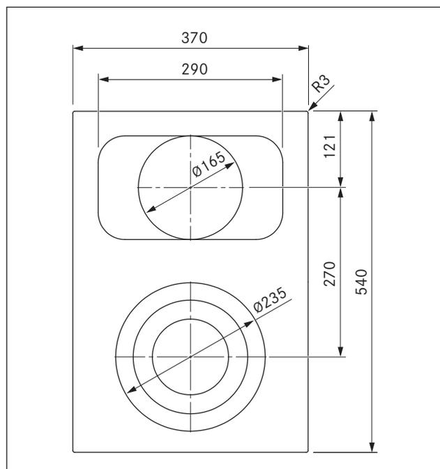
Fig. 3.4 PKC3B dimensiones del aparato vista en planta
