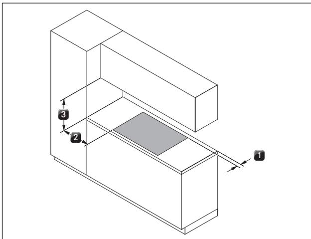
Fig. 5.17 Distancias mínimas con un montaje girado 180°
