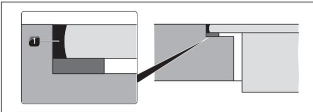
Fig. 5.25 Silicona de sellado para montaje enrasado
