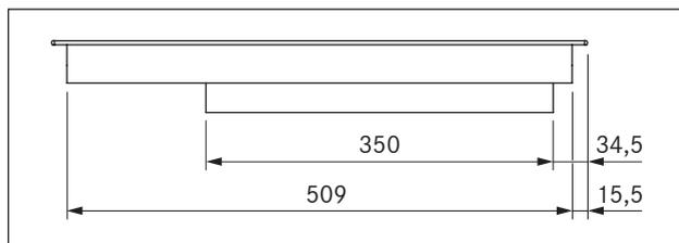
Fig. 3.6 PKC3B dimensiones del aparato vista lateral
