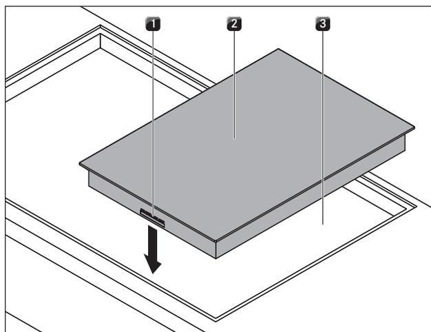
Fig. 5.14 Colocación de la placa de cocción
