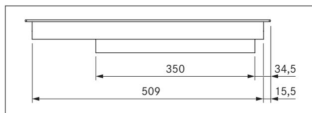
Fig. 3.3 PKC32 dimensiones del aparato vista lateral
