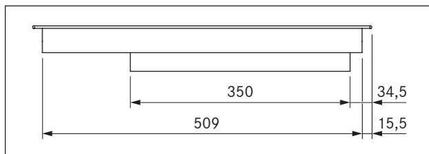
Fig. 3.6 PKC3B Dimensioni apparecchio vista laterale
