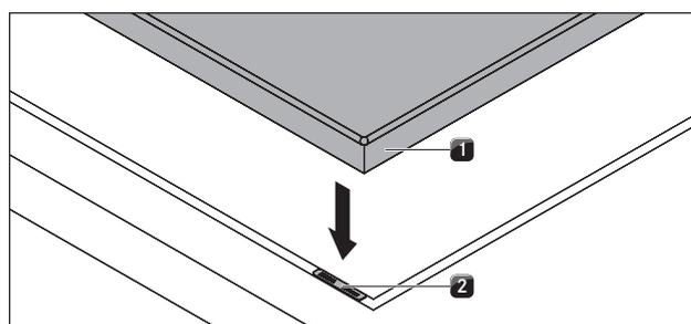
Fig. 5.15 Piano cottura e pannelli di compensazione altezza
