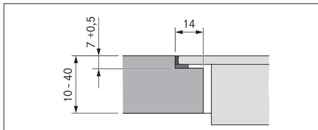
Fig. 5.4 Dimensioni dell'incassatura per montaggio a filo piano
