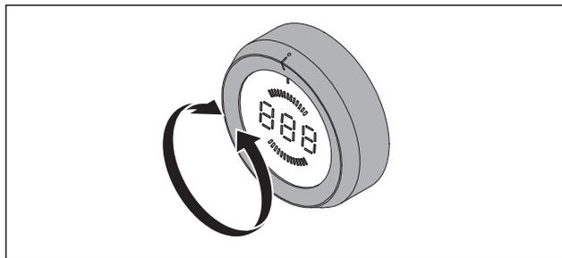
Fig. 6.4 Spegnimento della zona di cottura
