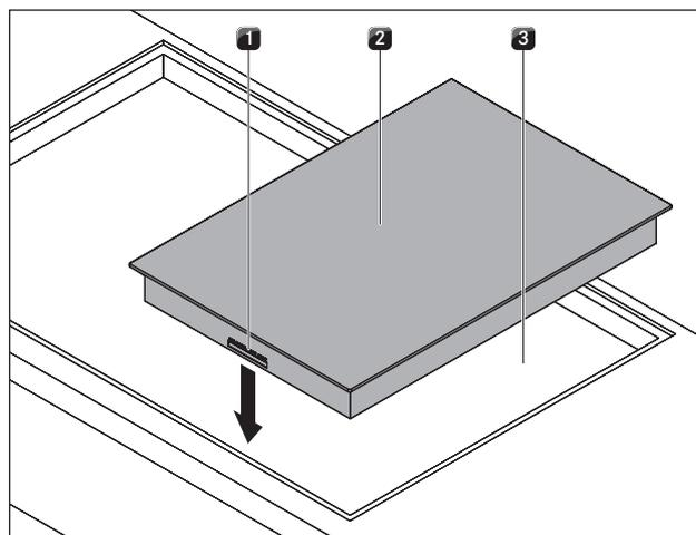
Fig. 5.14 Inserire il piano cottura
