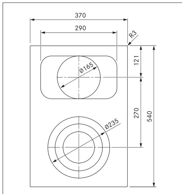
Fig. 3.4 PKC3B Dimensioni apparecchio vista da sopra
