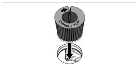
obr. 7.7 Nasazení filtru s aktivním uhlím do otvoru odsavače
