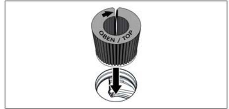
Abb. 7.7 Aktivkohlefilter in Abzugsöffnung einsetzen
