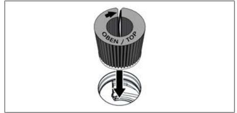
Fig. 7.7 Colocación del filtro de carbón activo en la abertura del extractor
