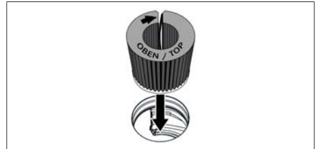
Kuva 7.7 Aktiivihiiisuodattimen asettaminen tuloaukkoon
