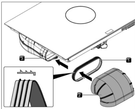
Fig. 9.24 Raccordement au système de canaux
