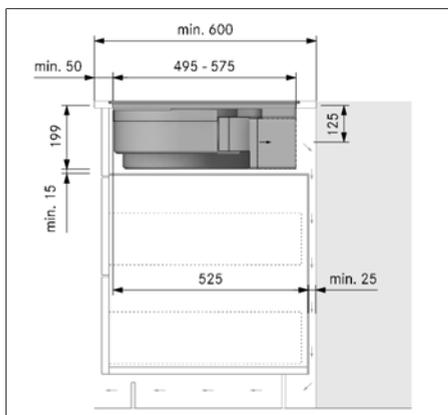
Fig. 9.16 Cotes de montage pour le recyclage d'air, variante B, profondeur du plan de travail 600 mm
