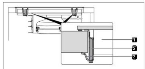
Fig. 9.23 Centrage et fixation de la table de cuisson
