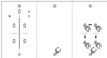
Fig. 9.31 Affichage d'ouverture du menu d'installation et de maintenance
