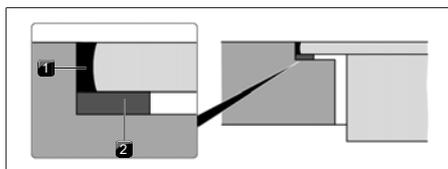
Fig. 9.18 Ruban d'étanchéité pour montage affleurant
