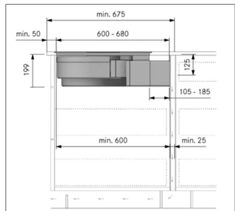
Fig. 9.14 Dimensions de montage pour le recyclage d'air, variante A, profondeur de plan de travail à partir de 675 mm
