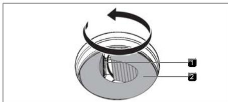
Fig. 7.4 Rotation du filtre à charbon actif dans son boîtier
