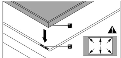
Fig. 9.21 Positionnement des plaques de compensation des hauteurs
