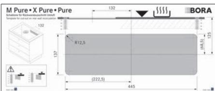
Fig. 9.12 Gabarit de découpe dans la paroi arrière
