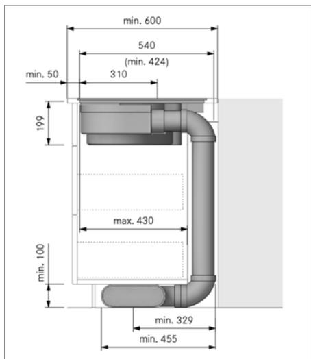
Fig. 9.9 Cotes de montage en mode évacuation d'air, profondeur du plan de travail 600 mm
