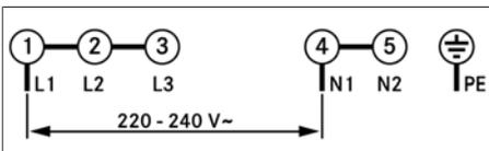
Fig. 9.28 Schéma de raccordement monophasé
