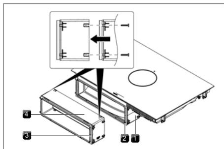
Fig. 9.15 Extension de la section télescopique
