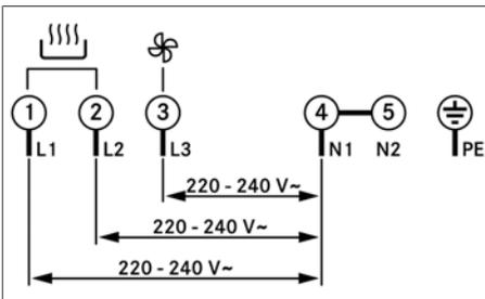
Fig. 9.27 Schéma de raccordement triphasé
