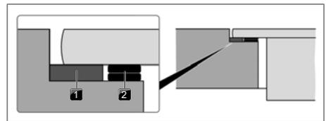
Fig. 9.22 Plaques de compensation des hauteurs
