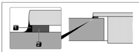
Fig. 9.17 Ruban d'étanchéité pour montage en saillie
