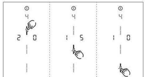
Fig. 6.4 Option de menu 5 : Sélection de la durée de la temporisation automatique :
