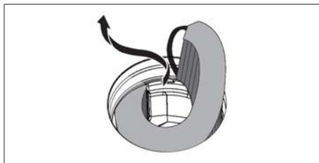
Fig. 7.5 Retrait du filtre à charbon actif de l'ouverture d'aspiration
