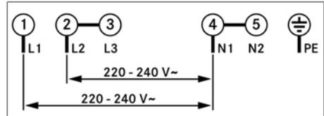
Fig. 9.29 Schéma de raccordement biphasé
