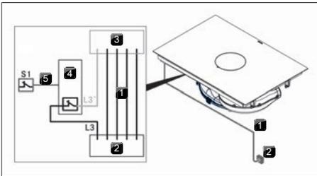
Fig. 9.26 Schéma de raccordement avec contact externe
