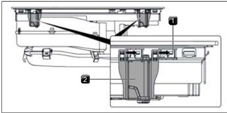
Fig. 9.19 Pose des pinces de montage
