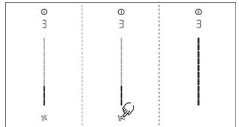
Fig. 6.3 Option de menu 3 : État du filtre et réinitialisation de l'indicateur d'entretien du filtre
