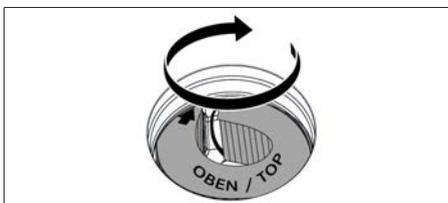
Fig. 7.8 Positionnement du filtre à charbon actif
