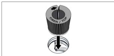
Fig. 7.7 Inserire il filtro al carbone attivo nell'apertura di aspirazione
