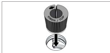
Afb. 7.7 Actieve-koolfilter in afzuigopening plaatsen
