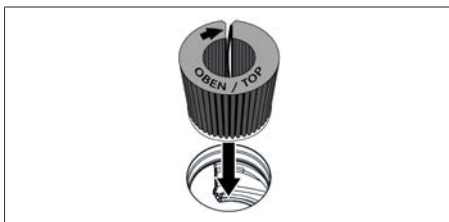
Fig. 7.7 Sett kullfilteret inn i avtrekksåpningen
