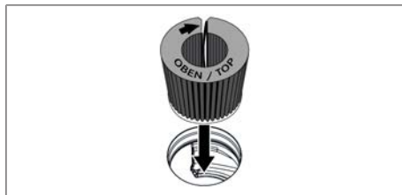
Rys. 7.7 Włożyć filtr z węglem aktywnym do otworu wyciągowego.
