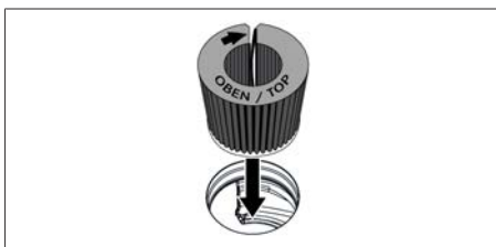
Sl. 7.7 Vstavljanje filtra z aktivnim ogljem v odprtino za odvod zraka
