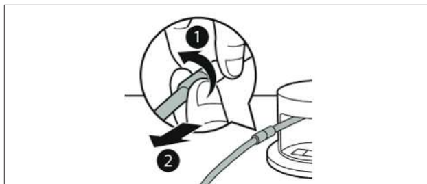
obr. 6.3 Uvolnění vakuovací hadice ze spojky
