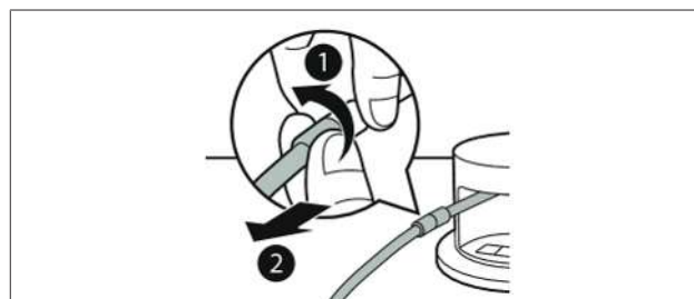
Fig. 6.3 Sådan løsnes vakuumslangen fra koblingen
