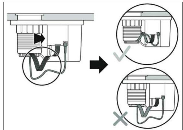
Abb. 8.18 Kabel anschließen
