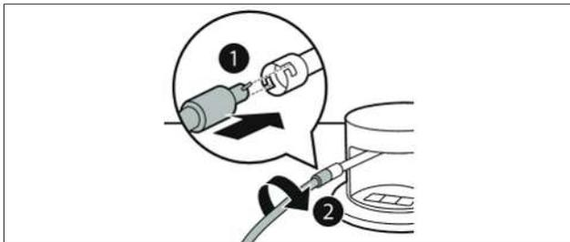
Abb. 6.4 Vakuumschlauch anschließen
