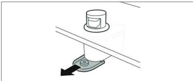
Abb. 6.5 Einbaugerät Auffangschale herausziehen
