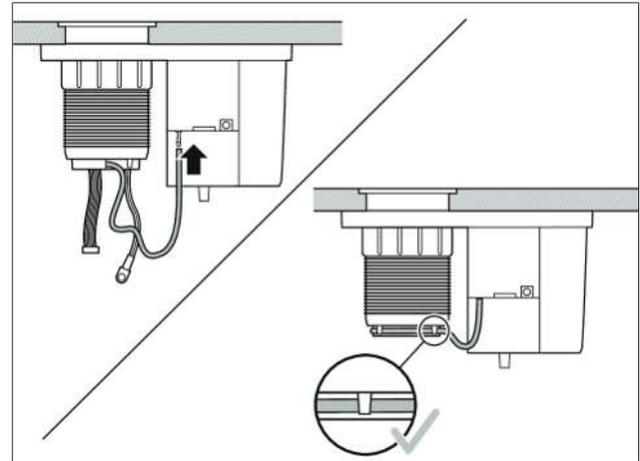
Abb. 8.17 Vakuum-Schlauch anschließen und mit den Halterungen fixieren
