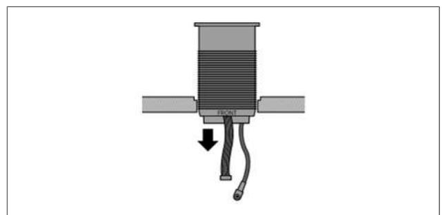
Abb. 8.13 Pop-up-Einheit einsetzen
