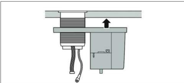
Abb. 8.15 Basiseinheit positionieren
