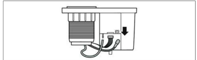
Abb. 8.11 Anschlüsse lösen
