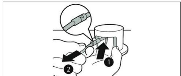
Abb. 6.2 Kupplung des Vakuumbschlauchs herausziehen
