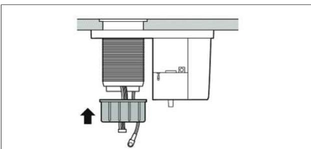
Abb. 8.16 Gerät befestigen
