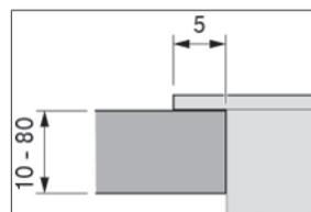
Abb. 8.5 Auflagemass Aufsatzmontage
