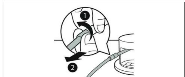
Abb. 6.3 Vakuumbschlauch aus der Kupplung lösen
