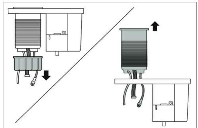
Abb. 8.12 Pop-up-Einheit demontieren
