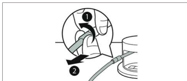
Fig. 6.3 Desconexión de la manguera de vacío del acoplamiento
