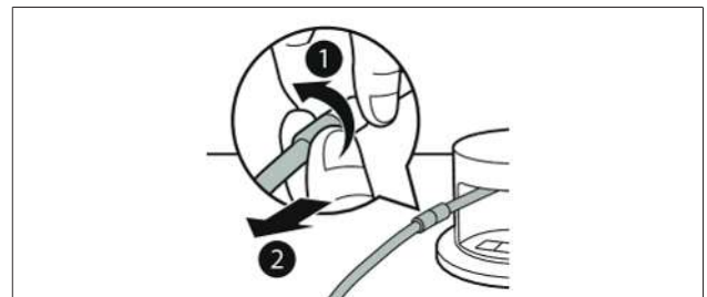
Kuva 6.3 Tyhjiöintiletkun irrottaminen liitoksesta
