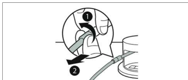
Fig. 6.3 Allentare il tubo per sottovuoto dal raccordo
