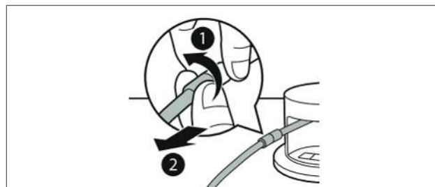
Afb. 6.3 De vacuümslang losmaken van de koppeling
