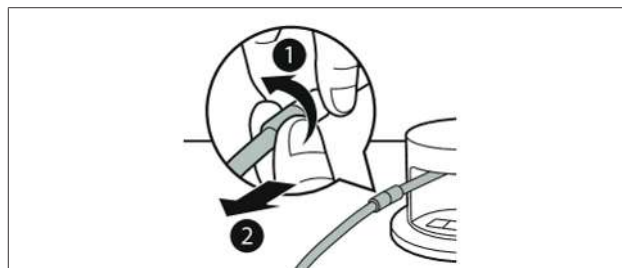
Rys. 6.3 Odłączanie węża do pakowania próżniowego od złącza
