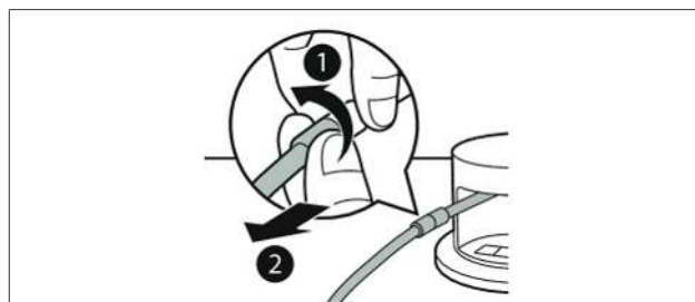
Sl. 6.3 Odstranjevanje vakuumske cevi iz spojke
