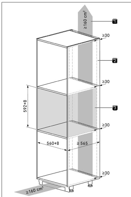
Fig. 8.1 Armoire d'encastrement
