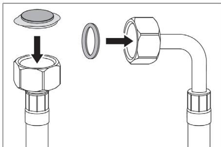
Fig. 8.13 Tuyau d'arrivée d'eau avec filtre à impuretés et joint
