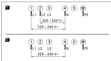
Fig. 8.14 Schémas de raccordement
