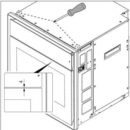
Fig. 8.15 Réglage de la distance entre l'unité de commande et la porte
