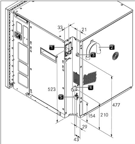
Fig. 8.10 Raccordement de l'appareil
