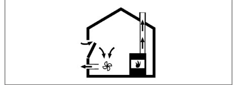
Kuva 10.2 Poistoilman asennus – oikein
