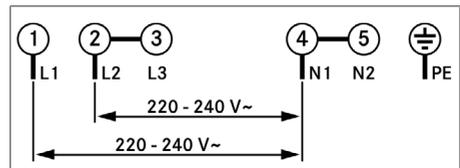
Fig. 10.29 Schéma de raccordement biphasé
