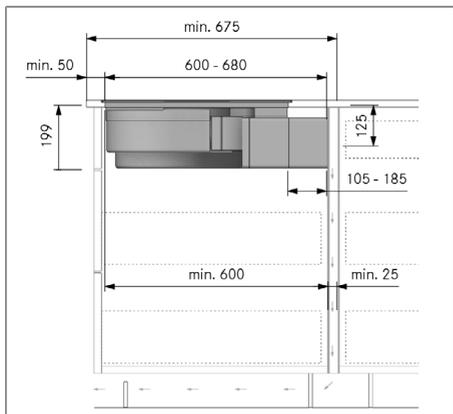
Fig. 10.14 Cotes de montage pour le recyclage d'air, variante A, profondeur du plan de travail à partir de 675 mm
