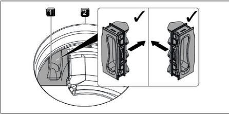
Fig. 8.10 Pose du clapet de changement de filtre
