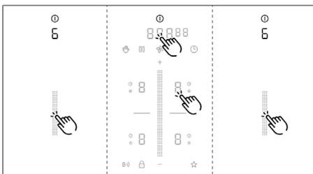
Fig. 7.7 Option de menu 6 : test des LED
