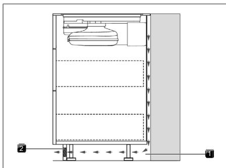
Fig. 10.10 Ouverture de retour de flux dans le socle
