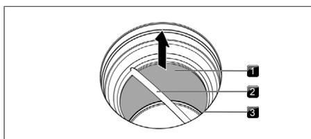
Fig. 8.2 Démontage du filtre à graisse en acier inoxydable
