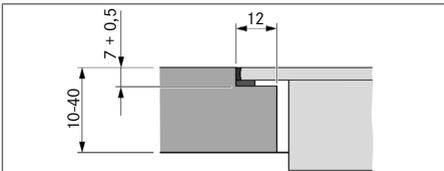
Fig. 10.6 Dimension de rainure pour montage affleurant
