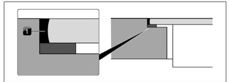
Fig. 10.36 Joint en silicone en montage affleurant
