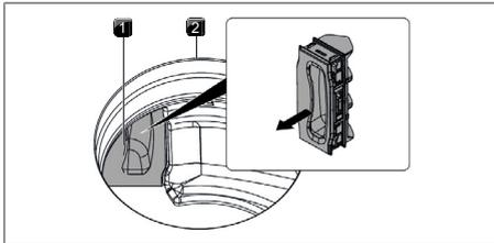
Fig. 8.4 Retrait du clapet de changement de filtre
