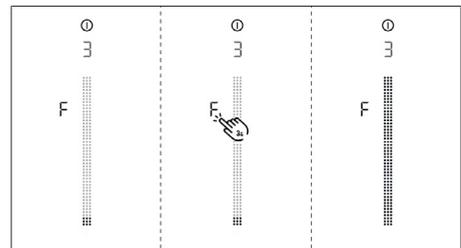
Fig. 7.4 Option de menu 3 : état du filtre et réinitialisation de l'indicateur d'entretien du filtre
