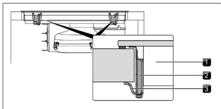
Fig. 10.23 Centrage et fixation de la table de cuisson
