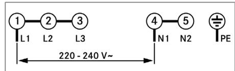
Fig. 10.28 Schéma de raccordement monophasé
