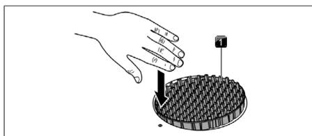
Fig. 8.1 Retrait de la buse d'aspiration
