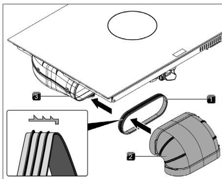
Fig. 10.24 Raccordement au système de canaux
