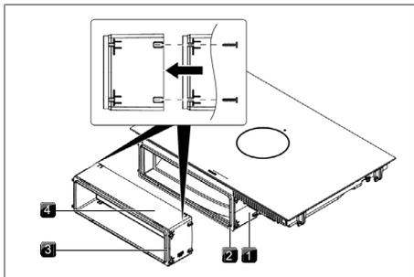
Fig. 10.15 Extension de la section télescopique
