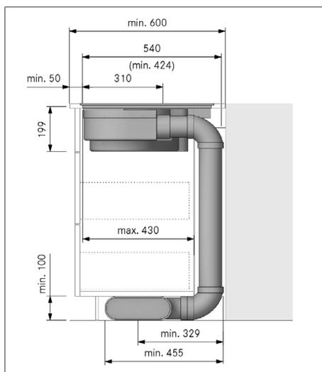
Fig. 10.9 Cotes de montage en mode évacuation d'air, profondeur du plan de travail 600 mm
