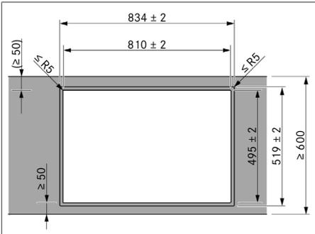
Fig. 10.5 Dimensions de découpe pour montage affleurant
