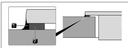
Fig. 10.17 Ruban d'étanchéité pour montage en saillie
