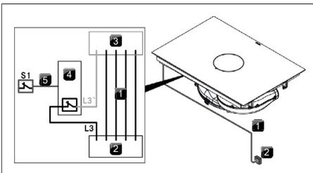
Fig. 10.26 Schéma de raccordement avec contact externe
