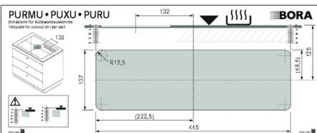
Fig. 10.12 Gabarit de découpe dans la paroi arrière
