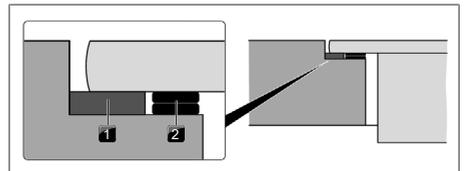
Fig. 10.22 Plaques de compensation des hauteurs
