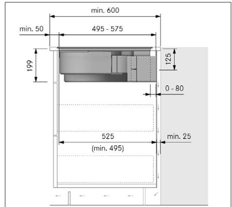
Fig. 10.13 Cotes de montage pour le recyclage d'air, variante A
