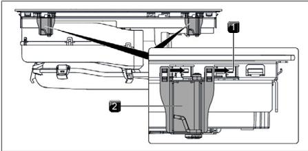
Fig. 10.19 Pose des pinces de montage
