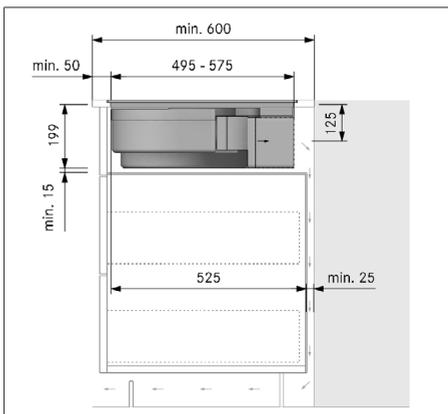
Fig. 10.16 Cotes de montage pour le recyclage d'air, variante B, profondeur du plan de travail 600 mm
