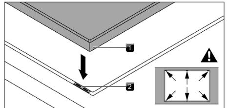
Fig. 10.21 Positionnement des plaques de compensation des hauteurs
