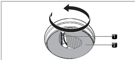
Fig. 8.5 Rotation du filtre à charbon actif dans son boîtier
