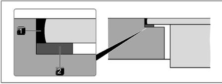
Fig. 10.18 Ruban d'étanchéité pour montage affleurant
