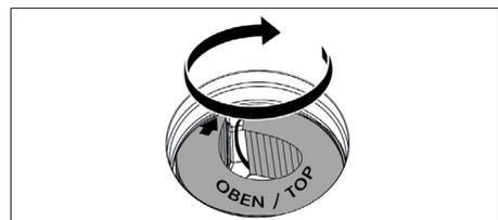
Fig. 8.9 Positionnement du filtre à charbon actif
