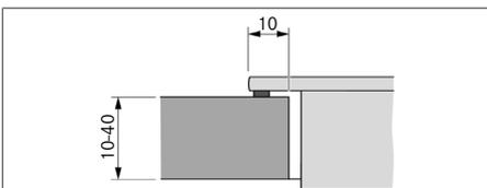
Fig. 10.8 Cote d'appui pour montage en saillie
