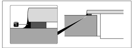
Fig. 10.35 Joint en silicone en montage en saillie
