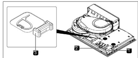
Fig. 10.30 Raccordements électriques de la table de cuisson
