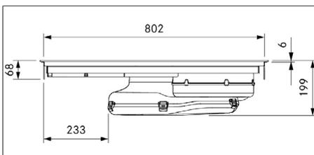
Fig. 3.2 PUXA2/R dimensões do aparelho vista frontal
