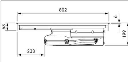
Fig. 3.5 PUXU2/R dimensões do aparelho vista frontal
