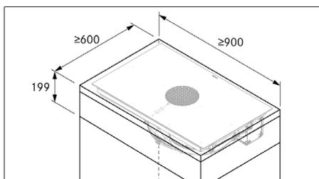
Fig. 10.4 Dimensões mínimas do móvel X Pure
