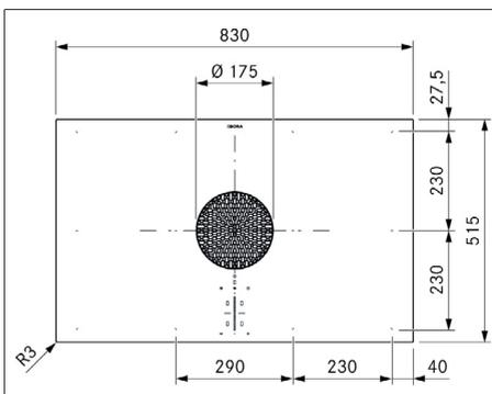
Fig. 3.1 PUXA2/R dimensões do aparelho vista de cima
