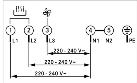
Fig. 10.27 Esquema de ligações trifásico
