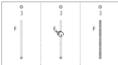
Fig. 7.4 Opção de menu 3: Repor o nível e a indicação de manutenção do filtro
