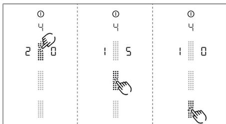
Fig. 7.5 Opção de menu 4: Selecionar a duração do atraso de desconexão automático
