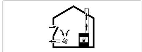
Fig. 10.2 Montagem do sistema de extração de ar – correta
