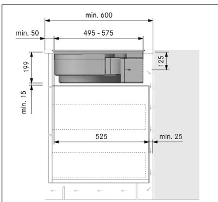
Fig. 10.16 Medidas de montagem para a circulação de ar, variante de montagem B, profundidade da bancada de 600 mm
