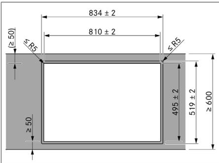
Fig. 10.5 Medidas de recorte para montagem à face
