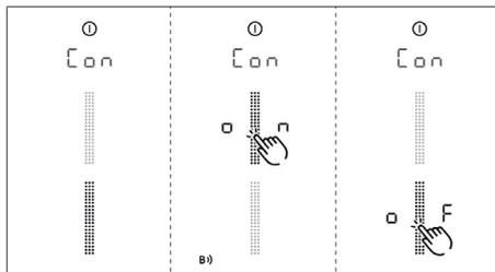
Fig. 7.1 Opção de menu Con: Conectividade (Connectivity)
