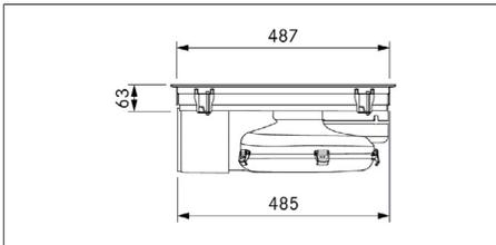
Fig. 3.6 PUXU2/R dimensões do aparelho vista lateral
