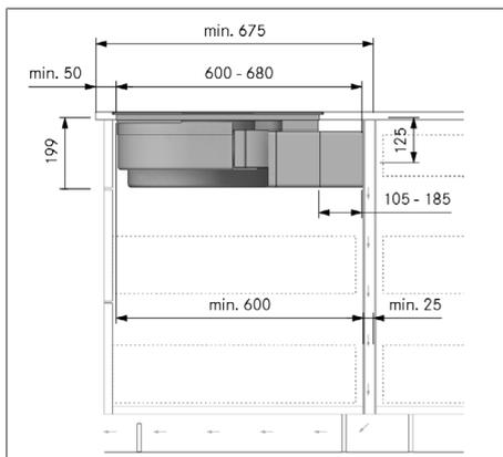
Fig. 10.14 Medidas de montagem para a recirculação de ar, variante de montagem A, profundidade da bancada a partir de 675 mm
