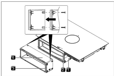
Fig. 10.15 Extensão da guia telescópica
