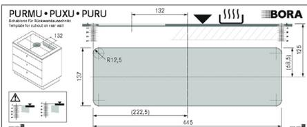
Fig. 10.12 Molde para o recorte do painel traseiro
