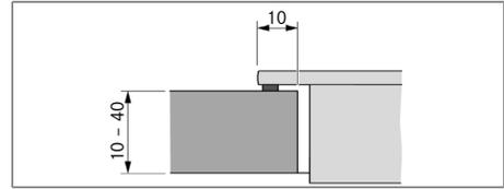
Fig. 10.8 Medida do apoio para montagem por sobreposição
