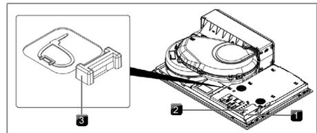
Fig. 10.30 Ligações elétricas da placa de cozinhar
