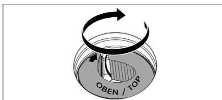
Fig. 8.9 Posicionar o filtro de carvão ativado na posição final
