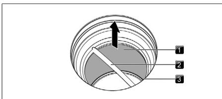
Fig. 8.2 Desmontar o filtro de gordura de aço inoxidável
