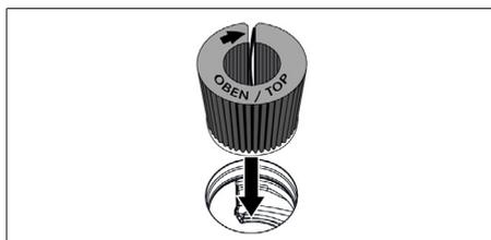
Fig. 8.8 Inserir o filtro de carvão ativado na abertura do exaustor
