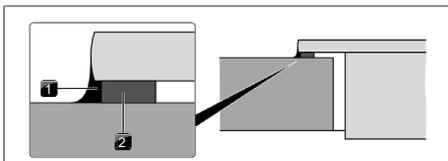
Fig. 10.17 Cinta vedante para montagem por sobreposição
