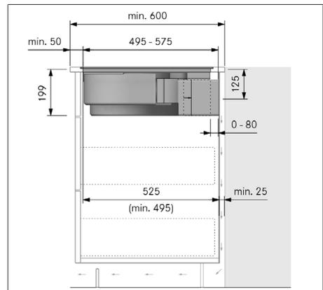
Fig. 10.13 Medidas de montagem para a recirculação de ar, variante de montagem A
