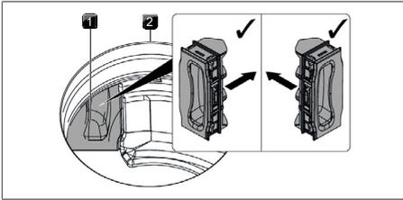
Fig. 8.10 Inserir a tampa de troca do filtro
