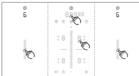
Fig. 7.7 Opção de menu 6: Teste dos LED
