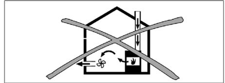
Fig. 10.1 Montagem do sistema de extração de ar – não permitida
