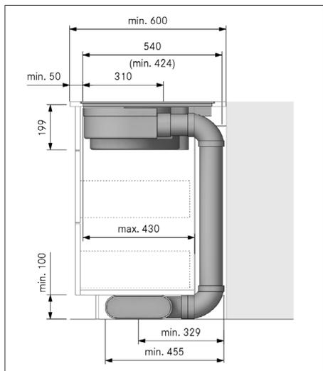
Fig. 10.9 Medidas de montagem para extração de ar, profundidade da bancada de 600 mm
