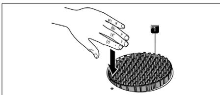
Fig. 8.1 Remover o bocal de entrada de ar
