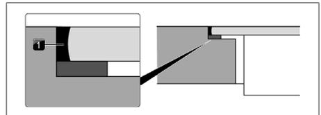
Fig. 10.36 Massa vedante de silicone na montagem à face
