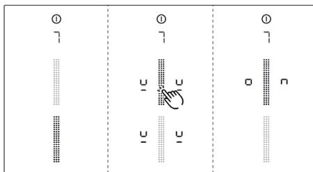
Fig. 7.8 Opção de menu 7: Detecção da panela permanente
