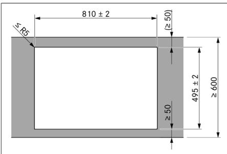
Fig. 10.7 Medidas de recorte para montagem por sobreposição
