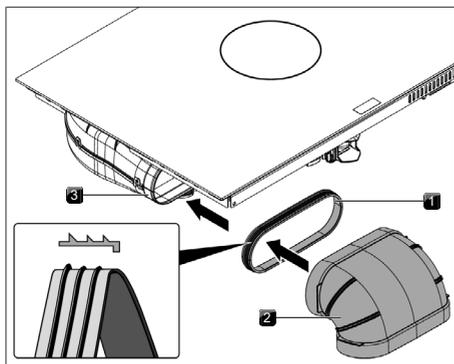
Fig. 10.24 Ligação ao sistema de condutas
