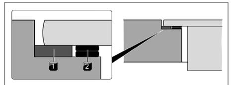
Fig. 10.22 Placas de compensação de altura
