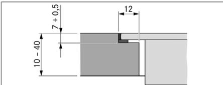
Fig. 10.6 Medida de recesso para montagem à face
