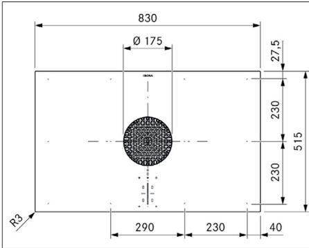
Fig. 3.4 PUXU2/R dimensões do aparelho vista de cima
