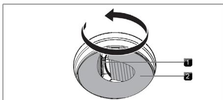
Fig. 8.5 Rodar o filtro de carvão ativado da carcaça do filtro
