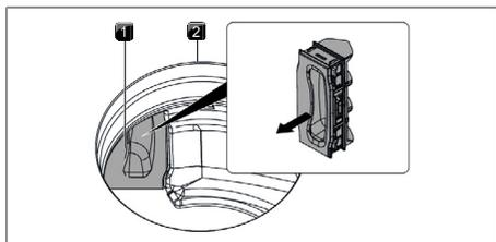
Fig. 8.4 Retirar a tampa de troca do filtro
