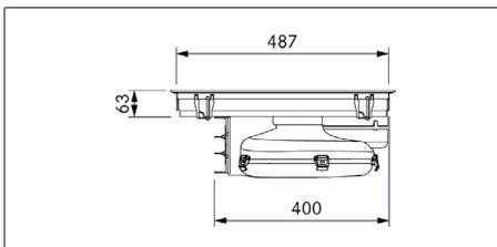
Fig. 3.3 PUXA2/R dimensões do aparelho vista lateral
