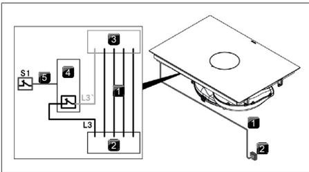
Fig. 10.26 Esquema de ligação com comutador externo
