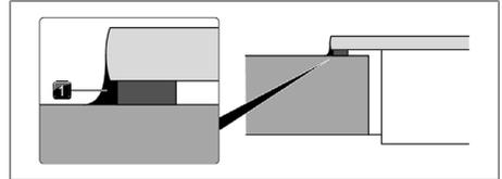
Fig. 10.35 Massa vedante de silicone na montagem por sobreposição
