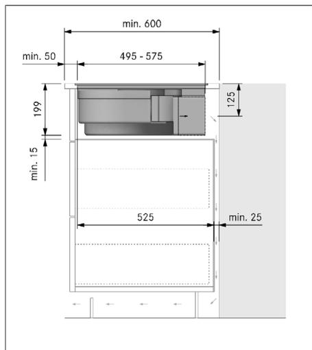
Abb. 9.27 Einbaumaße bei Umluft-Montagevariante B, Arbeitsplattentiefe 600 mm
