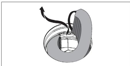
Abb. 7.8 Aktivkohlefilter aus der Einströmöffnung entnehmen
