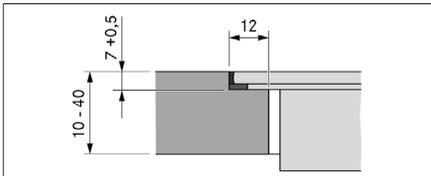
Abb. 9.11 Falzmaß für flächenbündige Montage
