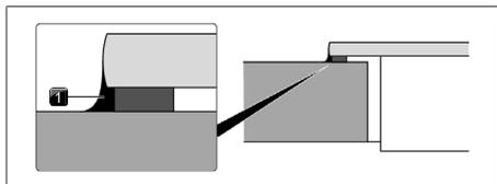
Abb. 9.47 Silikondichtmasse bei Aufsatzmontage
