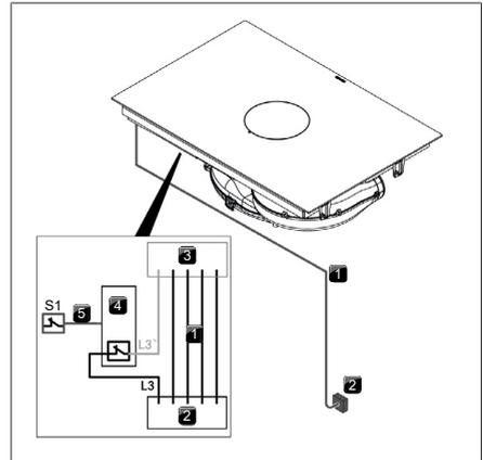
Abb. 9.38 Anschlusschema mit externem Schaltkontakt
