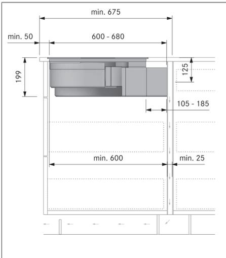
Abb. 9.31 Einbaumaße bei Umluft-Montagevariante A, Arbeitsplattentiefe ab 675 mm
