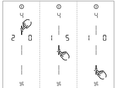
Abb. 6.4 Menüpunkt 4: Dauer der Nachlaufautomatik auswählen
