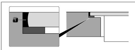
Abb. 9.48 Silikondichtmasse bei flächenbündiger Montage
