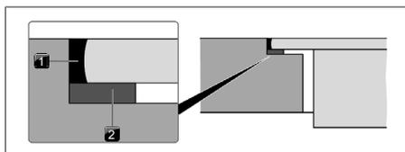
Abb. 9.16 Dichtungsband bei flächenbündiger Montage
