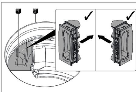
Abb. 7.12 Filterwechselklappe einsetzen
