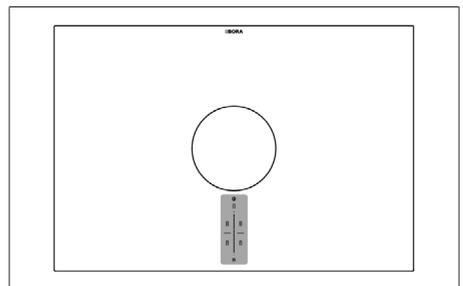
Abb. 4.4 Zentrales Touch-Bedienfeld mit Touch-Slider
