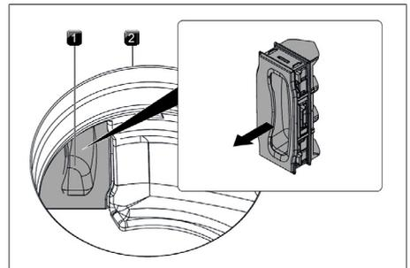
Abb. 7.6 Filterwechselklappe entfernen
