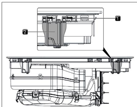
Abb. 9.30 Montageklappen anbringen
