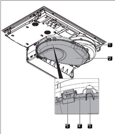
Abb. 7.5 Luftführungsgehäuse
