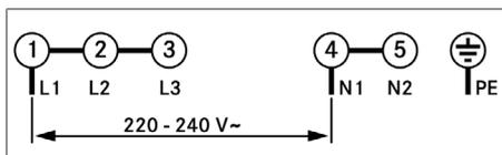
Abb. 9.40 Anschlusschema 1-Phasen-Anschluss
