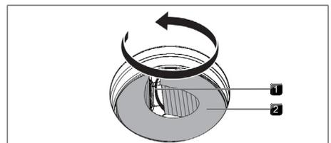
Abb. 7.7 Aktivkohlefilter aus dem Filtergehäuse drehen
