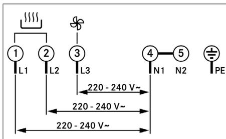
Abb. 9.39 Anschlusschema 3-Phasen-Anschluss
