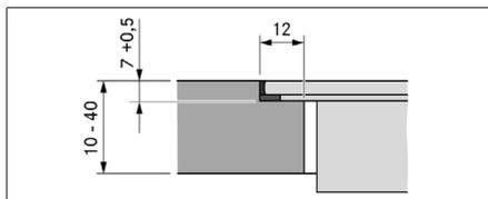
Abb. 9.7 Falzmaß für flächenbündige Montage
