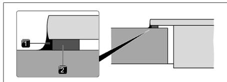
Abb. 9.28 Dichtungsband bei Aufsatzmontage
