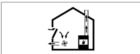
Abb. 9.2 Abluftmontage – korrekt
