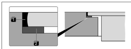
Abb. 9.29 Dichtungsband bei flächenbündiger Montage
