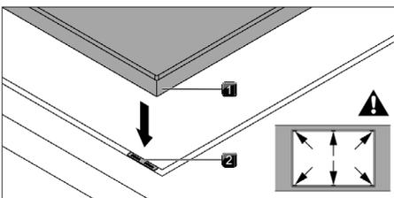
Abb. 9.19 Positionierung der Höhenausgleichsplatten
