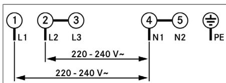
Abb. 9.41 Anschlusschema 2-Phasen-Anschluss
