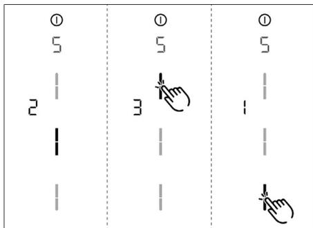
Abb. 6.5 Menüpunkt 5: Reaktionsgeschwindigkeit
