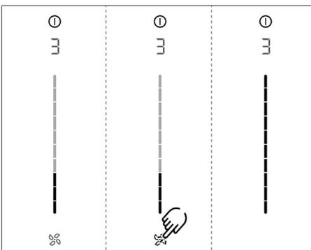
Abb. 6.3 Menüpunkt 3: Filterstand und Filterserviceanzeige zurücksetzen
