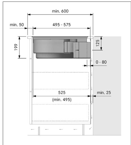
Abb. 9.26 Einbaumaße bei Umluft, Montagevariante A
