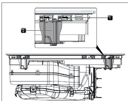
Abb. 9.17 Montageklappen anbringen
