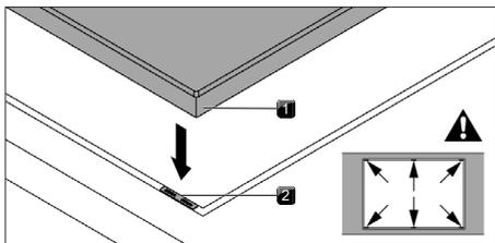
Abb. 9.34 Positionierung der Höhenausgleichsplatten
