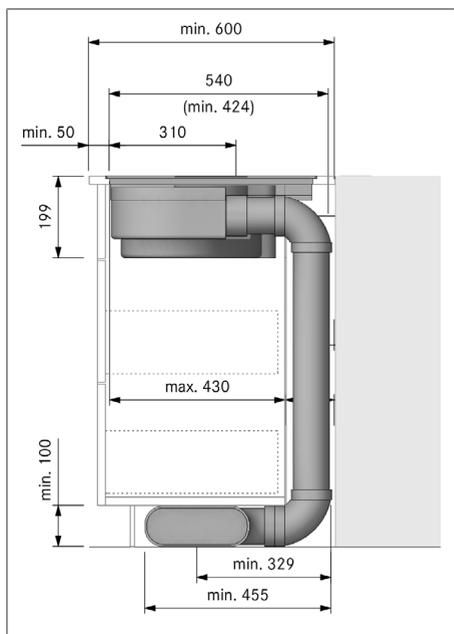
Abb. 9.14 Einbaumaße Abluft, Arbeitsplattentiefe 600 mm
