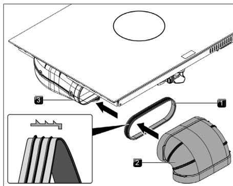
Abb. 9.22 Anschluss an Kanalsystem
