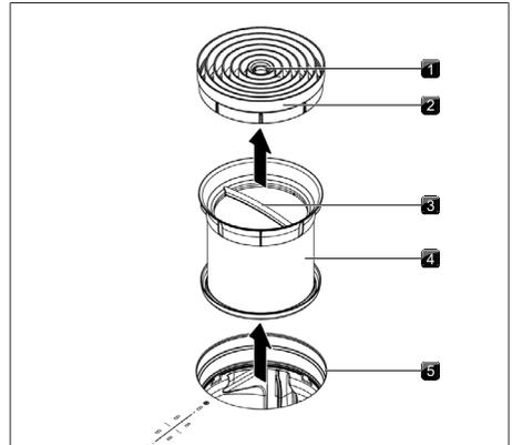
Abb. 7.3 Ausbau der Komponenten
