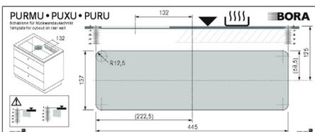
Fig. 9.25 Plantilla para el recorte del panel trasero
