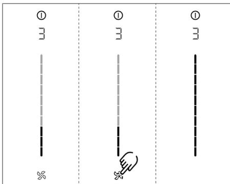
Fig. 6.3 Opción de menú 3: Reiniciar la vida útil del filtro y el indicador de servicio del filtro
