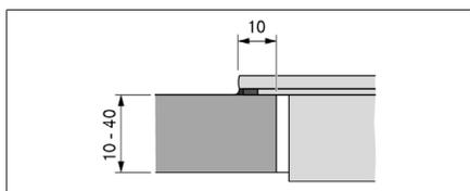
Fig. 9.9 Medida del apoyo para montaje superpuesto
