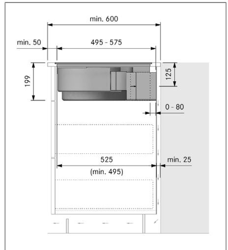
Fig. 9.26 Medidas de montaje con recirculación, variante de montaje A
