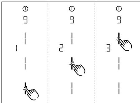
Fig. 6.9 Opción de menú 9: Desconexión de seguridad
