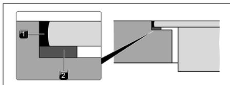
Fig. 9.29 Cinta selladora para montaje enrasado
