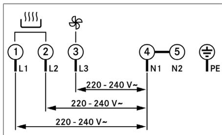
Fig. 9.39 Esquema de conexiones, conexión trifásica
