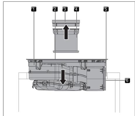
Fig. 9.33 Colocación de la placa de cocción en posición centrada
