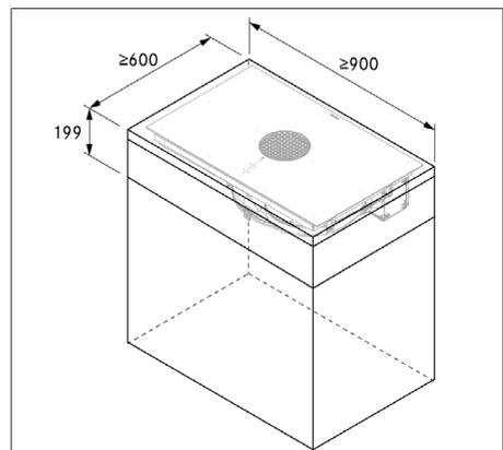
Fig. 9.4 Medidas mínimas de los muebles X Pure
