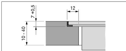
Fig. 9.11 Medida del rebaje para un montaje enrasado
