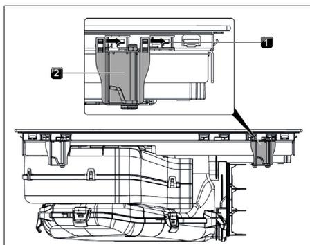
Fig. 9.30 Colocación de las abrazaderas de montaje
