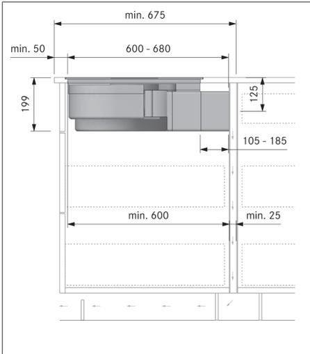
Fig. 9.31 Medidas de montaje para la variante de recirculación A, profundidad de la encimera 675 mm o más
