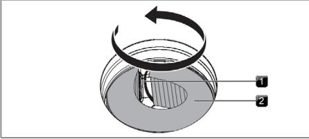
Fig. 7.7 Desenroscar el filtro de carbón activo para extraerlo de su carcasa
