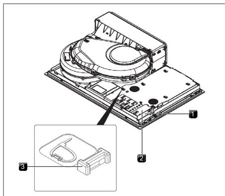
Fig. 9.42 Conexiones eléctricas de la placa de cocción
