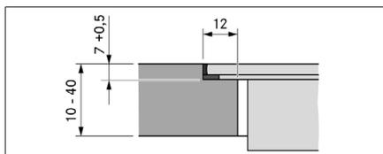
Fig. 9.7 Medida del rebaje para un montaje enrasado
