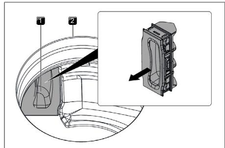
Fig. 7.6 Retirar la trampilla para el cambio del filtro
