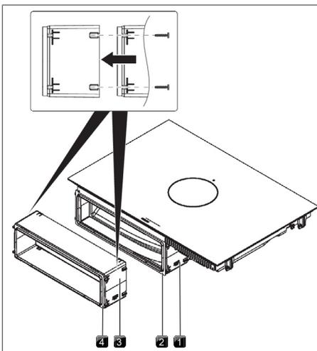
Fig. 9.32 Prolongación de la extensión telescópica
