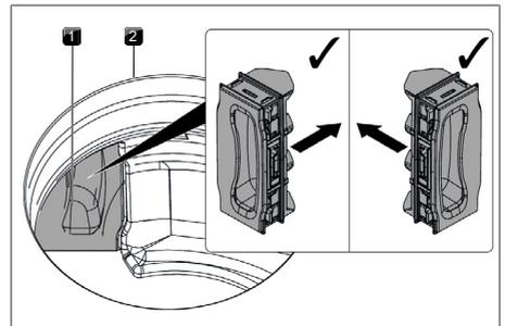
Fig. 7.12 Colocación de la trampilla para el cambio del filtro
