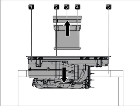
Fig. 9.18 Colocación de la placa de cocción en posición centrada
