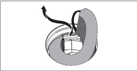
Fig. 7.8 Extracción del filtro de carbón activo de la abertura de entrada
