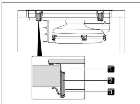
Fig. 9.36 Fijación de la placa de cocción en posición centrada
