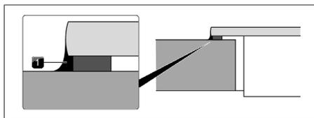
Fig. 9.47 Silicona de sellado para montaje superpuesto
