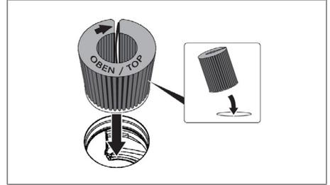
Fig. 7.10 Colocación del filtro de carbón activo en la abertura del extractor
