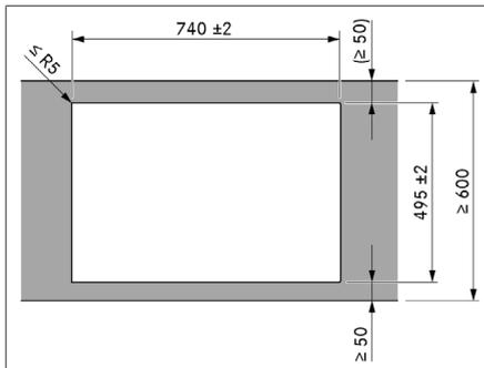
Fig. 9.12 Medidas del recorte para montaje superpuesto
