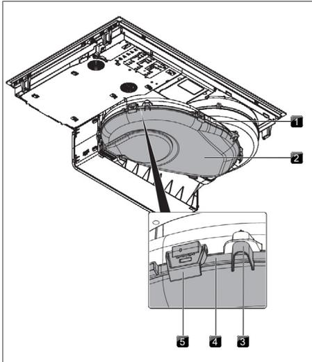
Fig. 7.5 Carcasa de conducción del aire
