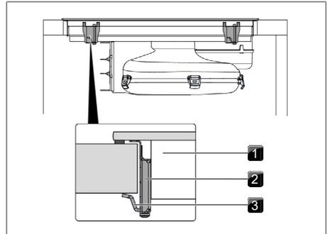
Fig. 9.21 Fijación de la placa de cocción en posición centrada
