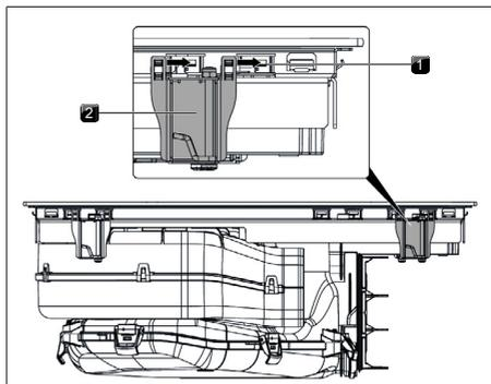
Fig. 9.17 Colocación de las abrazaderas de montaje
