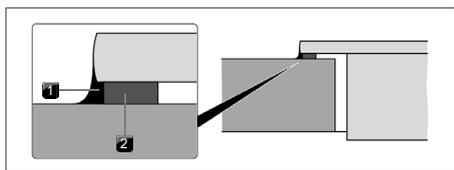
Fig. 9.15 Cinta selladora para montaje superpuesto
