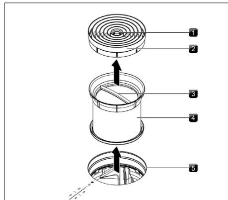
Fig. 7.3 Desmontaje de los componentes
