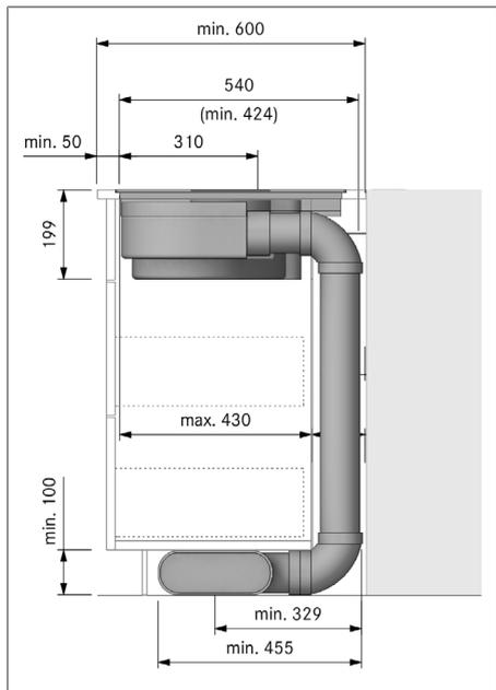
Fig. 9.14 Medidas de montaje extracción al exterior, profundidad de la encimera 600 mm
