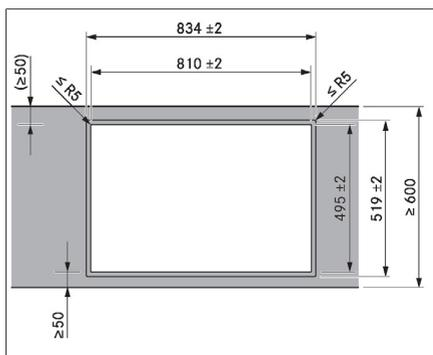
Fig. 9.6 Medidas del recorte para montaje enrasado
