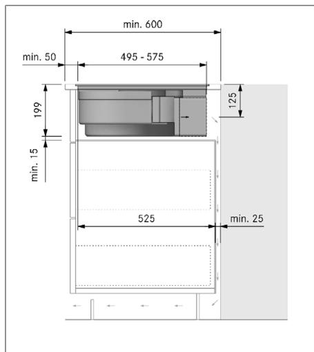
Fig. 9.27 Medidas de montaje para la variante de recirculación B, profundidad de la encimera 600 mm
