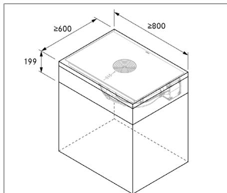
Fig. 9.5 Medidas mínimas de los muebles Pure
