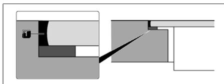
Fig. 9.48 Silicona de sellado para montaje enrasado
