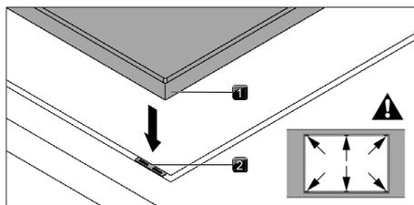
Fig. 9.34 Ubicación de placas de compensación de altura
