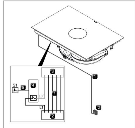
Fig. 9.38 Esquema de conexiones con contacto de conmutación externo
