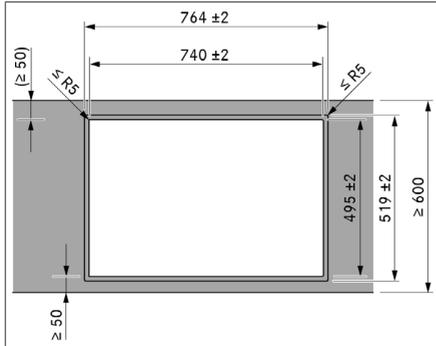
Fig. 9.10 Medidas del recorte para montaje enrasado
