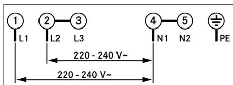
Fig. 9.41 Esquema de conexiones, conexión bifásica
