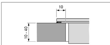
Fig. 9.13 Medida del apoyo para montaje superpuesto
