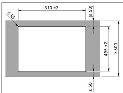
Fig. 9.8 Medidas del recorte para montaje superpuesto
