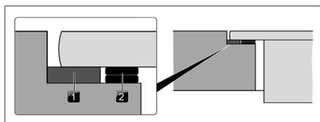
Fig. 9.35 Placas de compensación de altura
