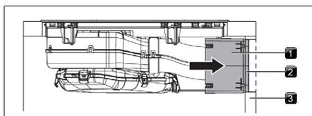
Fig. 9.37 Conexión del panel trasero
