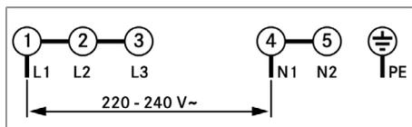
Fig. 9.40 Esquema de conexiones, conexión monofásica
