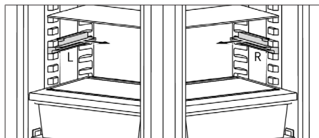
Sl. 8.7 Odstranjevanje montažnih vodil multi-pladnja
