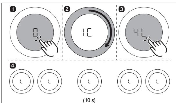
für einen Kochvorgang deaktivieren / deactivating for a cooking session / desactivar para un proceso de cocción / désactivez pour un processus de cuisson / disattivazione per un processo di cottura / voor een kookproces deactiveren
