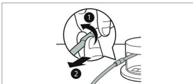
obr. 6.3 Uvolnění vakuovací hadice ze spojky
