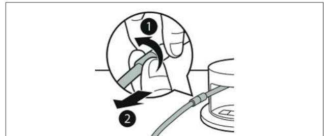
Abb. 6.3 Vakuumschlauch aus der Kupplung lösen
