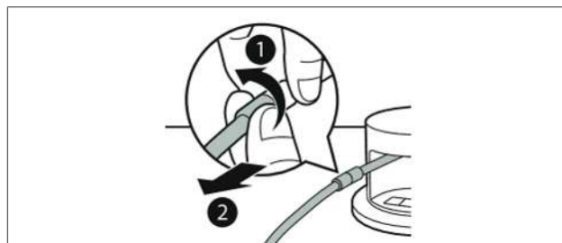
Kuva 6.3 Tyhjiöintiletkun irrottaminen liitoksesta
