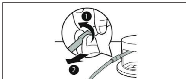
Fig. 6.3 Déconnexion du flexible de mise sous vide du raccord
