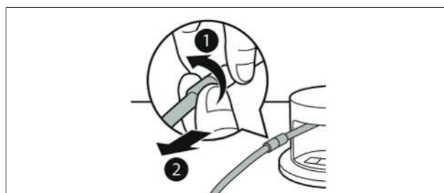
Afb. 6.3 De vacuümslang losmaken van de koppeling
