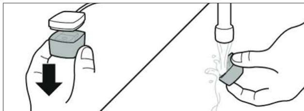
Rys. 6.1 Czyszczenie zbiornika cieczy
