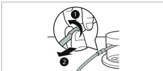
Obr. 6.3 Uvoľnenie vákuovacej hadice zo spojky
